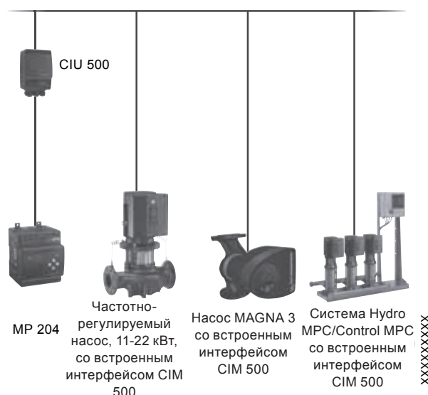
Рис. 142 CIM/CIU 500 в сети PROFINET IO
