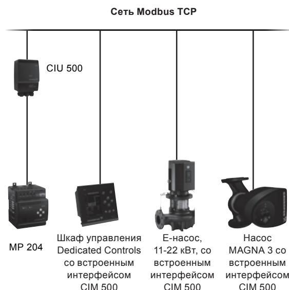
Рис. 144 CIM/CIU 500 в сети Modbus TCP
