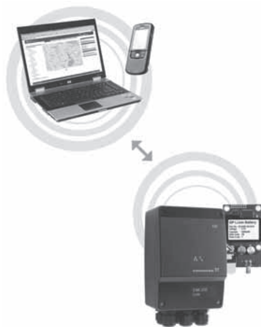
Рис. 128 Устройство CIU/CIM для беспроводной передачи данных
