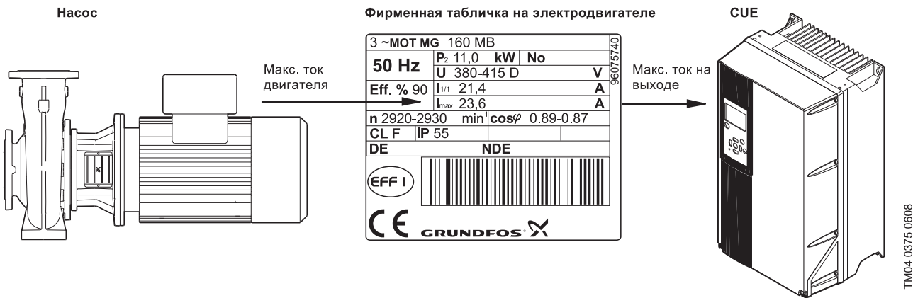
Рис. 104 Подбор CUE на основании максимального тока двигателя
