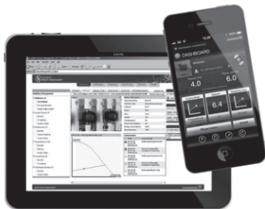
Рис. 136 Система дистанционного управления Grundfos (GRM) для осуществления контроля через Интернет и работы с SMS
